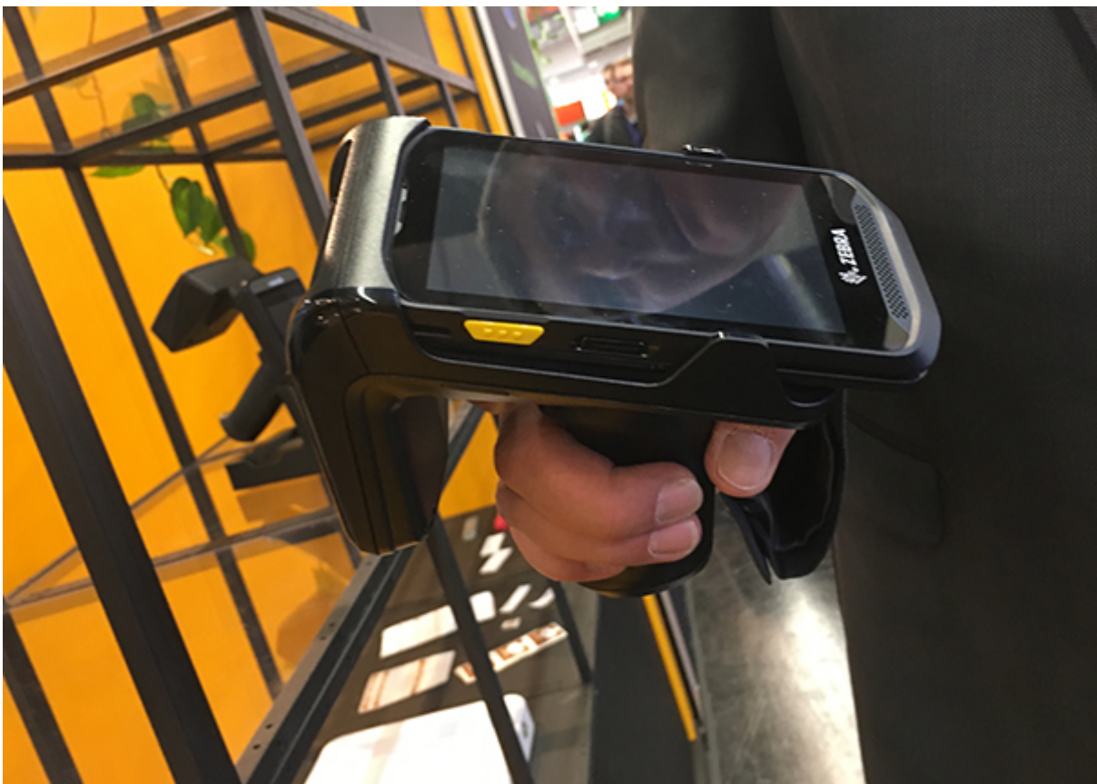
Scanner von Zebra mit integriertem RFID- und Barcodeleser
