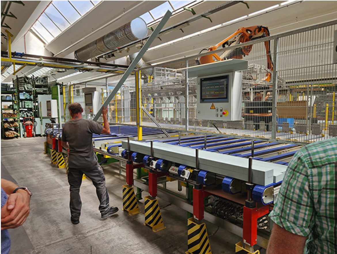
Roboterzelle zur Teileabstapelung nach Plattenzuschnitte – Angesteuert über cimERP
